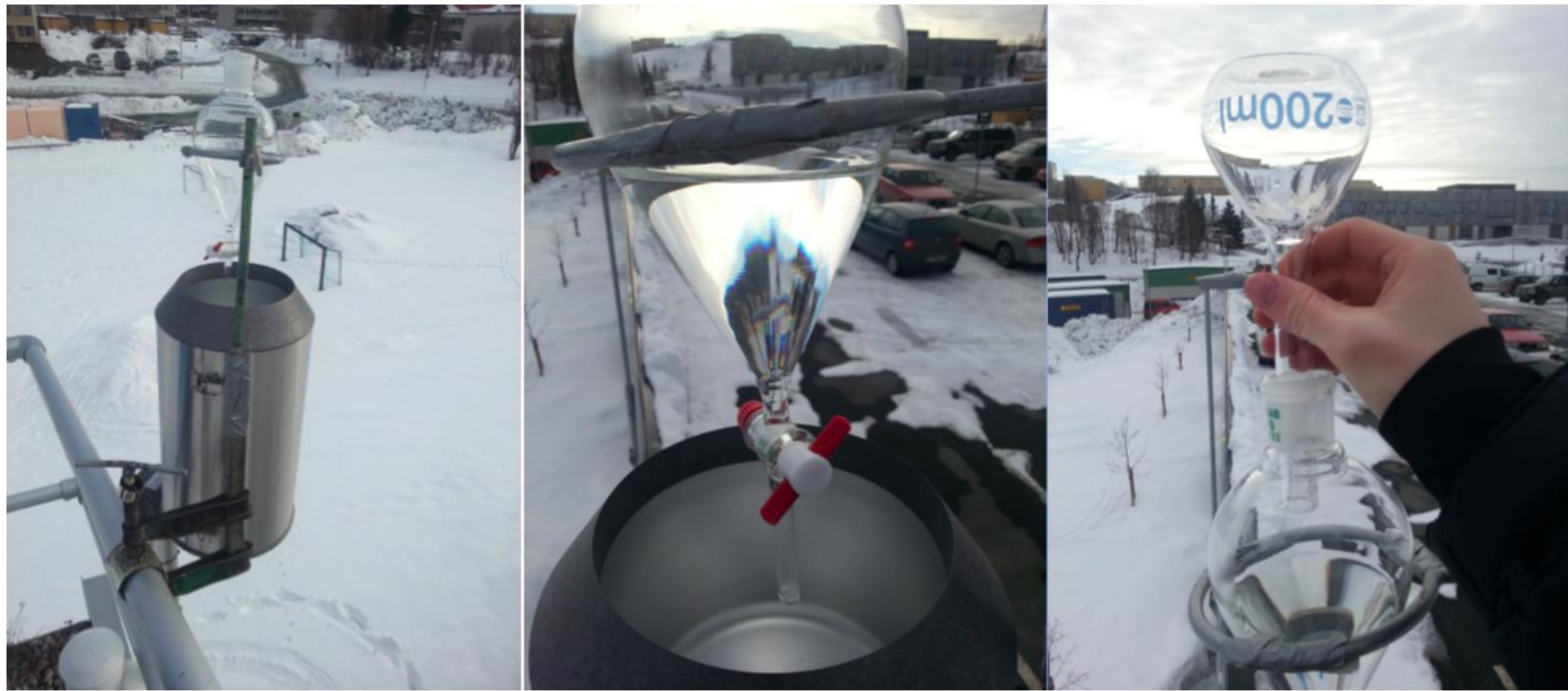
Figur 13: Statisk kalibrering av nedbørmåler.
