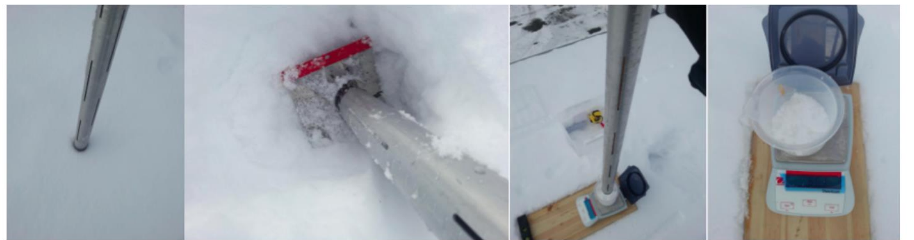
Figur 13: Statisk kalibrering av nedbørmåler.
